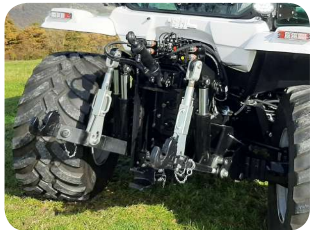
Applicazione per l'aggancio rapido degli attrezzi con triangolo. Application for quick coupling of implements with triangle. Application pour l'accrochage rapide des outils avec triangle. Vorrichtung für Schnellschluss der Anbaugeräte mit Anbaudreieck.
