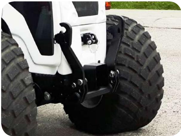
Presa di forza frontale e sollevatore anteriore con bracci removibili. Frontal power takeoff and front hitch with removable arms. Prise de force frontale et système de relevage antérieur avec bras mobiles. Nebenabtrieb und Frontlader mit abnehmbaren Armen.
