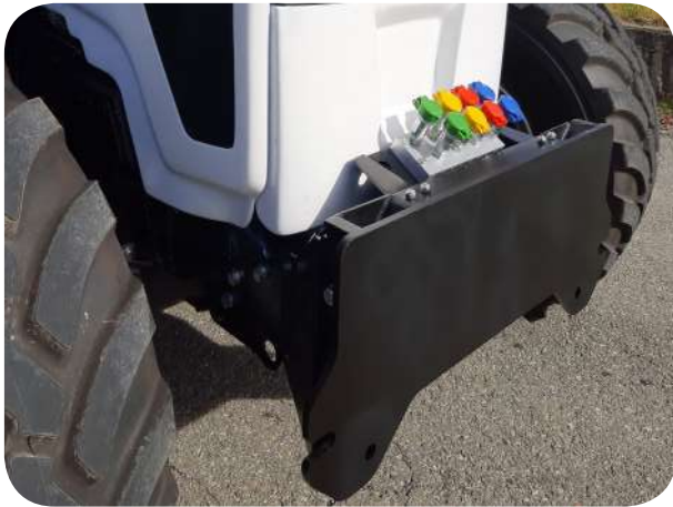
Applicazione staffatura frontale con piastra UNI per spartineve. Front bracket with UNI plate for snow plough. Application d'étrier frontal avec plaque UNI pour chasse-neige. Anbringung Konsole vorn mit UNI-Platte für Schneeräumer.
