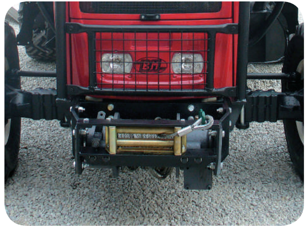
Applicazione con verricello frontale da 5700 kg. Application with 5700 kg frontal winch. Application avec treuil 5700 kg. Winde 5700 kg.
